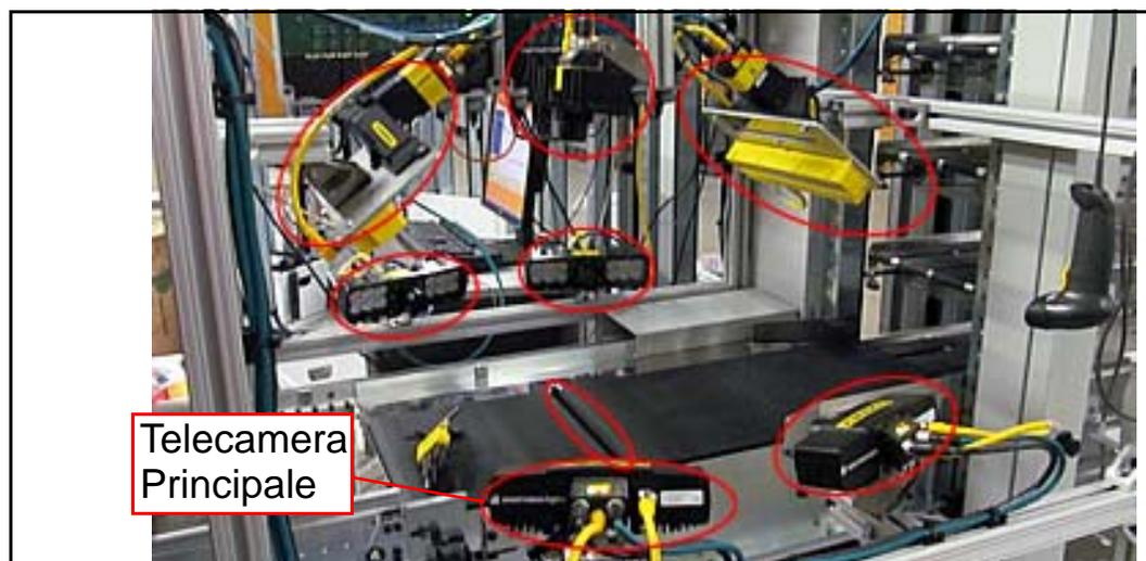
**Figura 3-3: Scanner di codici a barre**
