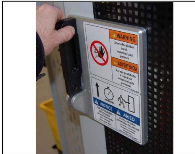
**Figura 2-18: Dettaglio interblocco porta**
