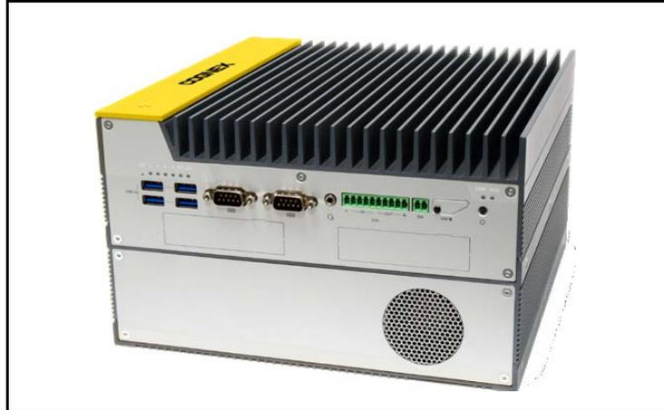
**Figura 3-4: Computer RTM del tunnel di scansione**
