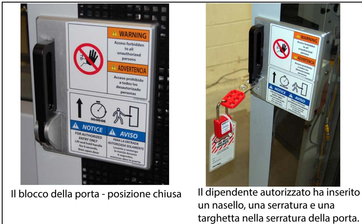
**Figura 2-3: Procedura di sicurezza Lockout/Tagout**
